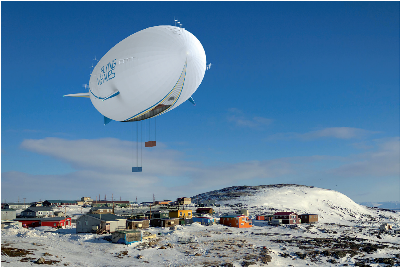
Der Lastenaustausch soll mittels ausgeklügeltem Kransystem ohne Landung funktionieren und wäre so für Transporte an schwierig zu erreichende Orte prädestiniert.
