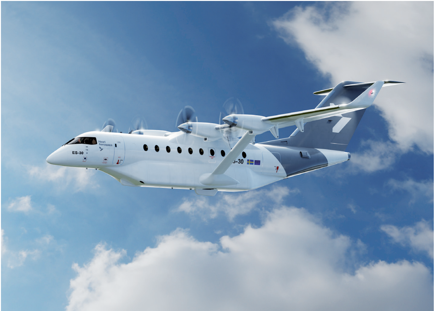
Die Heart Aerospace ES-30 schafft rein batteriebetrieben nur gerade 200 Meilen und eine maximale Flughöhe von 20 000 Fuss.
