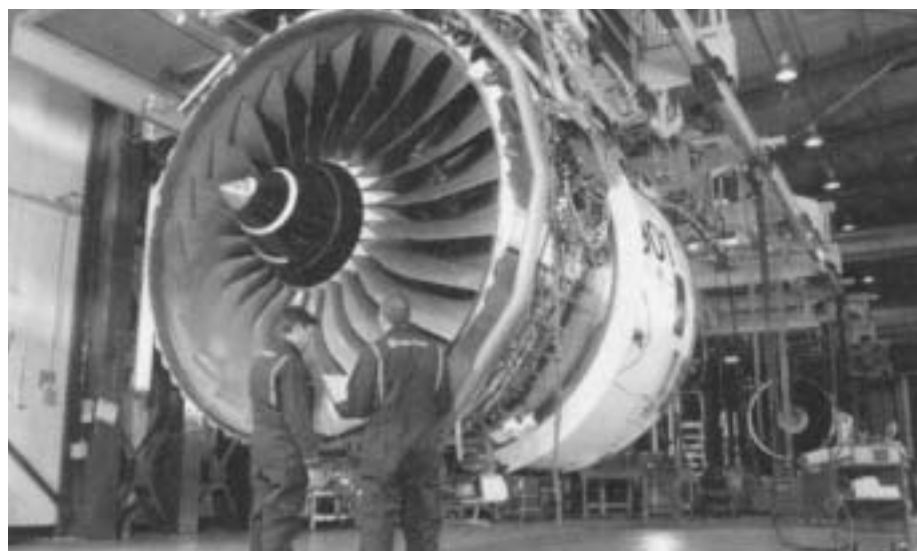
«Knapp drei Meter Durchmesser hat der Fan des Dreiwellen-Triebwerkes Rolls-Royce Trent 900»
